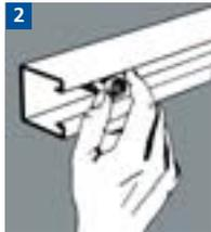
Une rotation de 90 degrés dans le sens des aiguilles d'une montre permet d'encliquer les fentes du boulon avec les rebords incurvés du profilé. Les raccords peuvent être placés n'importe où le long du profilé.
