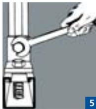
Resserrez le boulon à l'aide d'une clé à molette pour permettre aux dents de l'écrou de bloquer fermement le boulon dans les rebords incurvés du profilé, simulant ainsi la solidité des serres d'un étau.
